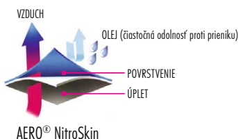
AERO® NitroSkin (povrch)
